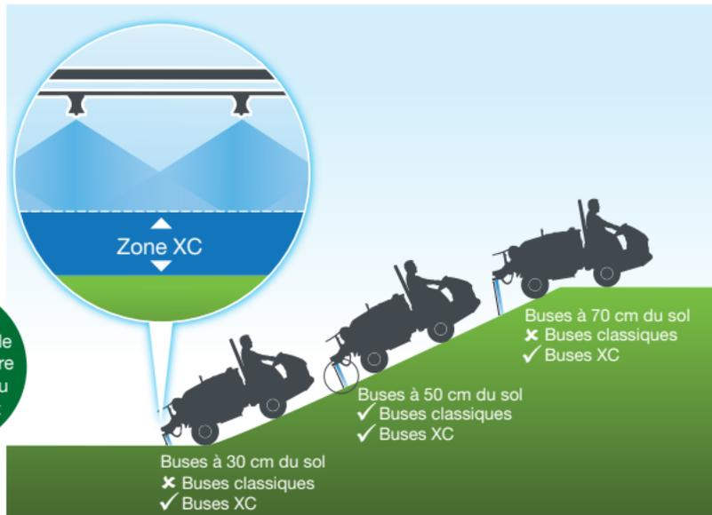
La buse pour gazon XC entièrement redessinée de Syngenta a été conçue avec un orifice de forme distinctive qui assure une couverture uniforme même en terrain ondulé, aux endroits où la hauteur de la buse est réduite par les inégalités du terrain.
